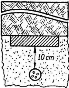
Arena apisonada con recubrimiento de ladrillos
